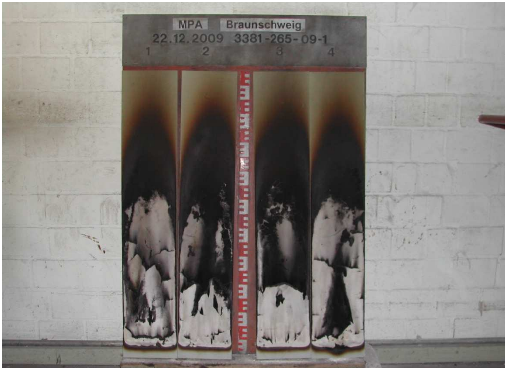
Aussehen der Prüfkörper 1 (grau) nach der Brandschachtprüfung
