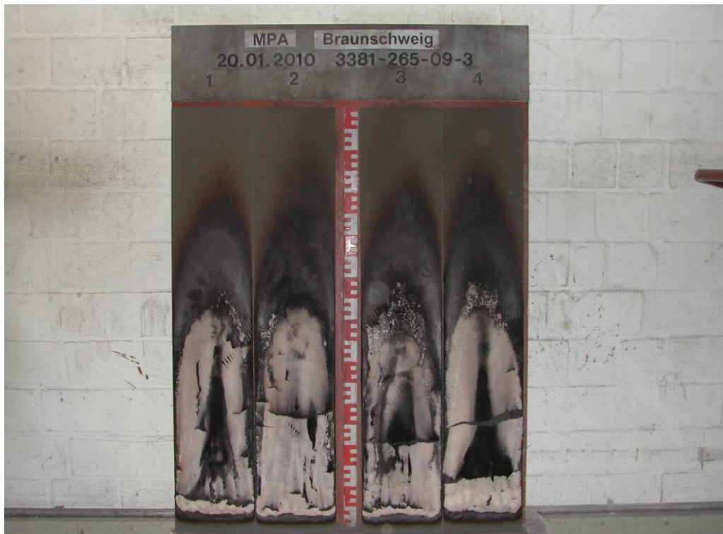
Aussehen des Prüfkörper 3 (schwarz) nach der Brandschachtprüfung
