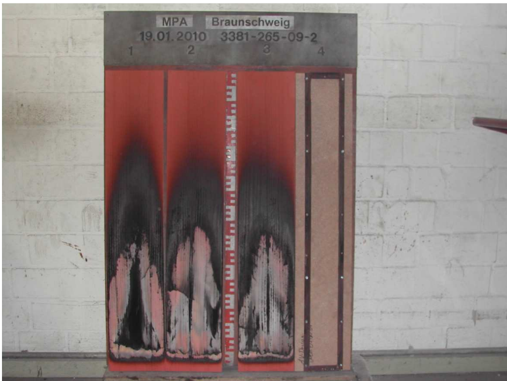
Aussehen der Prüfkörper 2 (rot) nach der Brandschachtprüfung
